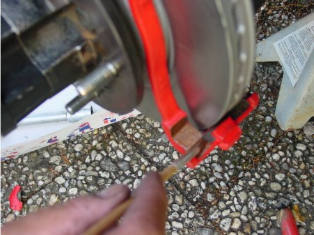
Doe wat kopervet op de contactplaatsen tussen remblokken en steunen. Zorg er voor dat er geen vet op de remschijf of remblokken komt..
