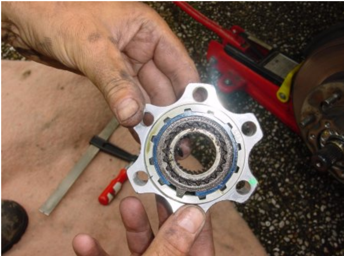
Zicht op de voorzijde van de vrijloopnaaf. Het blauwe is een borgveer.
