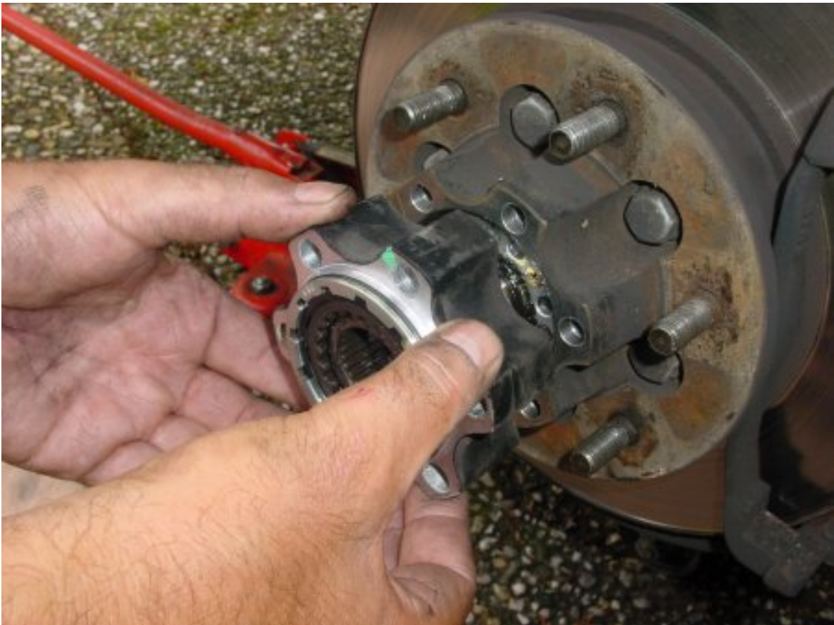
Nu kan je voorzichtig het huis van de vrijloopnaaf van de as trekken.
