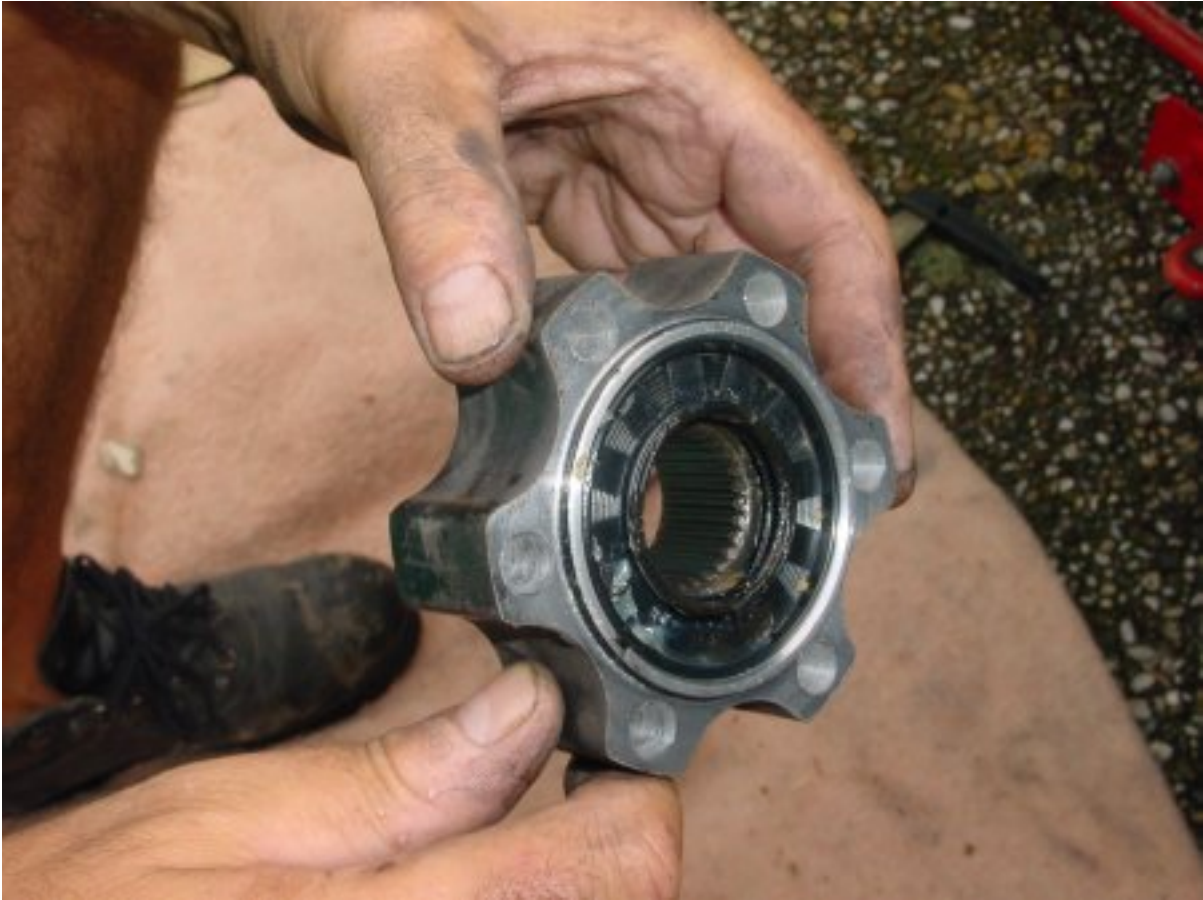
Zicht op de binnenzijde van het naafhuis.
