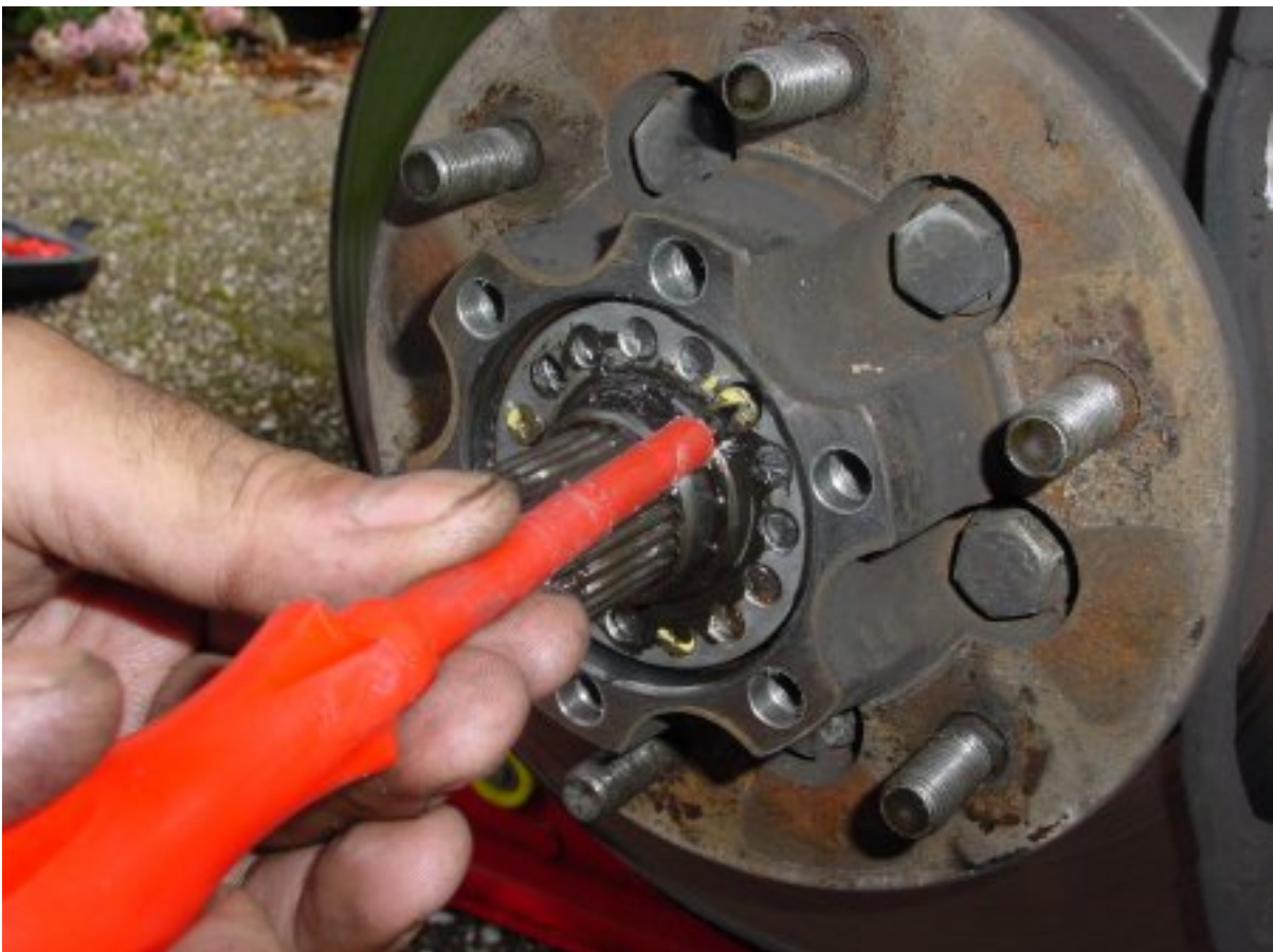
Verwijder de drie blokkeerschroeven van de centrale asmoer.
