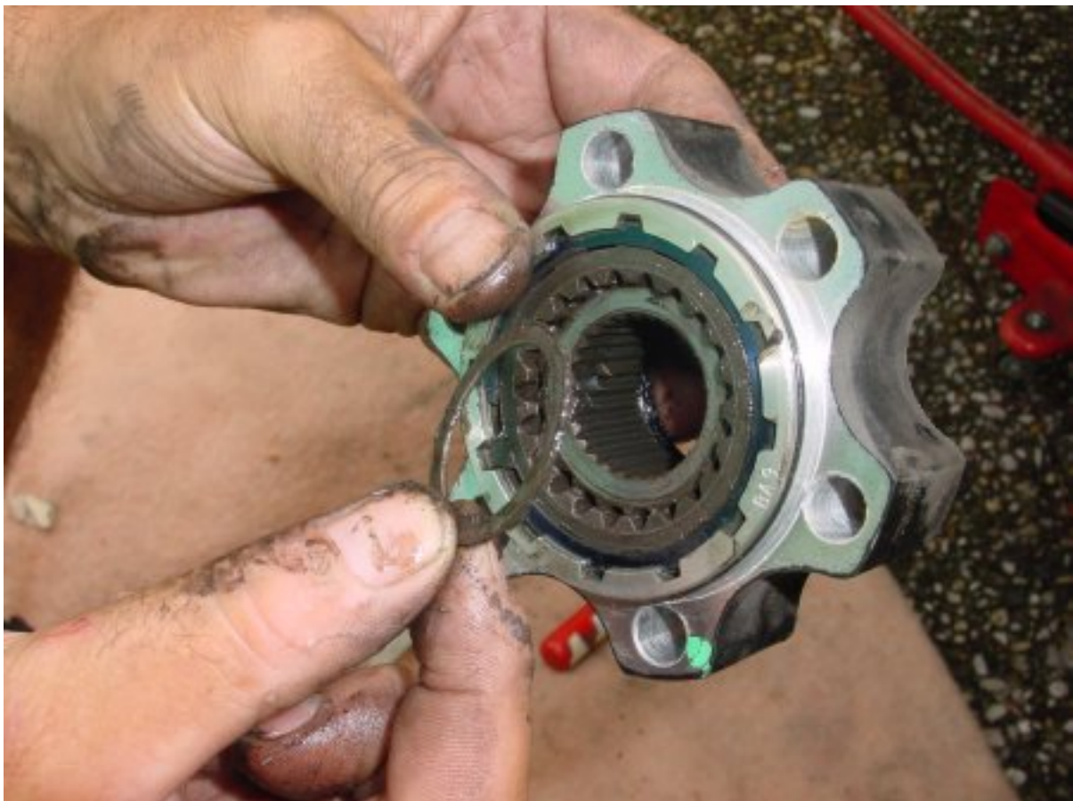
Tussen de zegering en het binnen deel van de vrijloopnaaf zitten een of meerdere shims.
