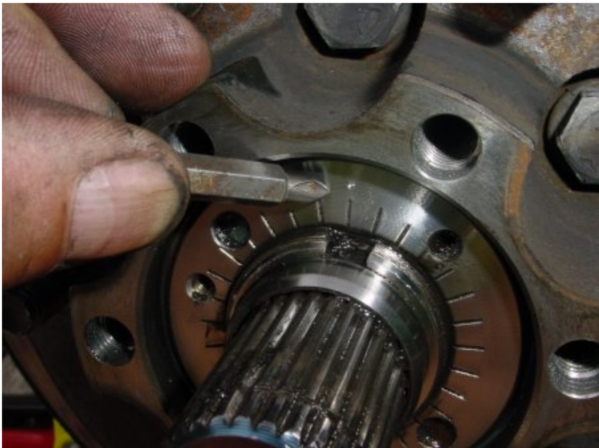
Markeer de centrale moer zodat je weet hoe strak hij zat.
